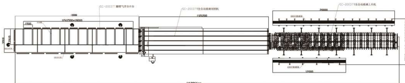
全球最大超大板SC20m x 3.7m切割线布局图
